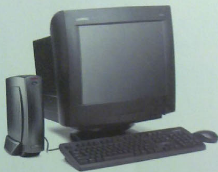
Рис. 1. Системный блок Windows-терминала занимает небольшую площадь и может быть смонтирован на стену.
